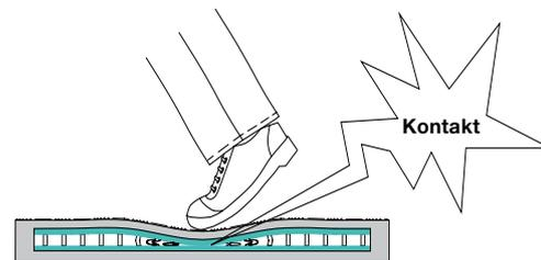
Die Schaltmatte besteht aus zwei von einander getrennten stromführenden Stahlplatten. Isolierende Trennstreifen halten die Platten auf Abstand. Wird die druckempfindliche Schaltmatte betätigt, wird zwischen den Stahlplatten ein elektrischer Querschluss hergestellt. Der angeschlossene Sicherheitsrelaisbaustein wertet dieses Signal aus und schaltet die gefahrbringende Bewegung ab.
